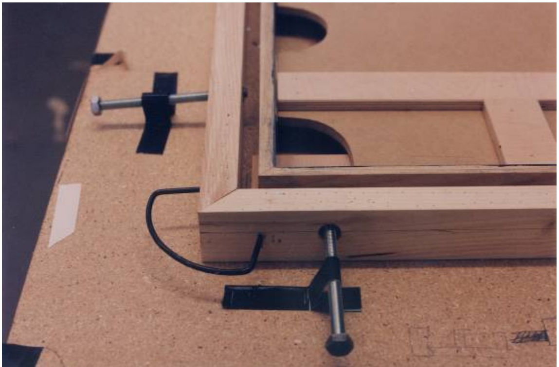
6. Detail von 5, Rampa-Muffen mit Gewindestangen.
